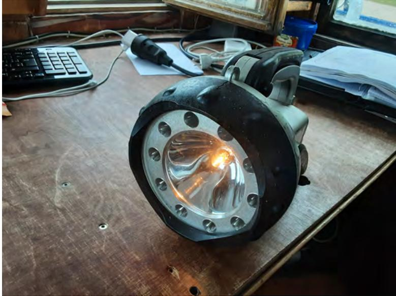
Abbildung 5: Tagessignalscheinwerfer
