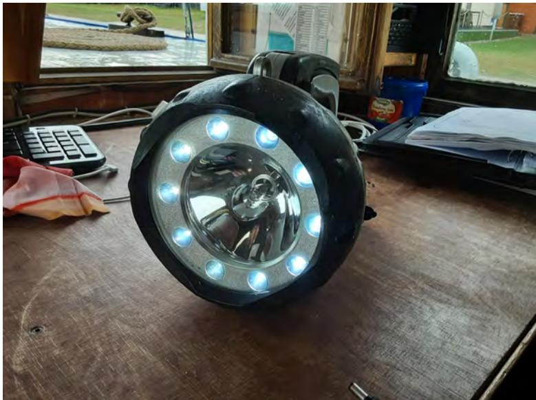
Abbildung 6: Tagessignalscheinwerfer
