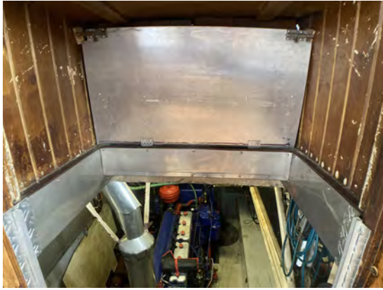
(a) Riegel für aufgelegtes Blech, hinten: Scharniere
